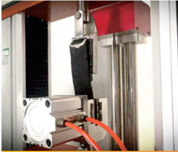
卷材与混凝土剥离强度测试
